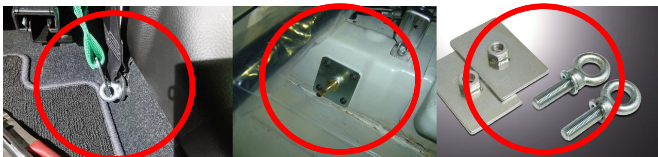
純正ベルトのボルト穴を使う ストレスプレートをボルトで固定 もちろん溶接付けが一番
