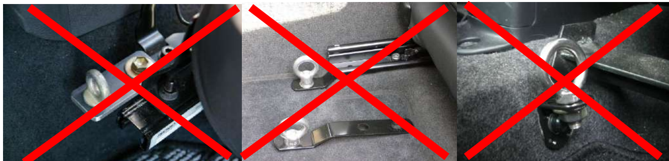
シートレールに延長ステー シートレールのボルトから延長ステー アイボルト自体が強度不足
